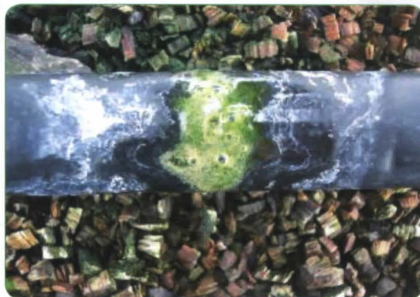
Foto 74. Algas en la cinta de riego.
