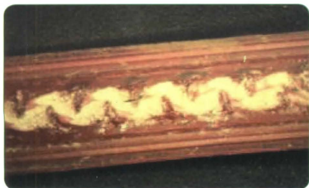
Foto 73. Precipitados de calcio en el gotero.
