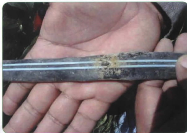
Foto 76. Barro en el exterior de la cinta.
