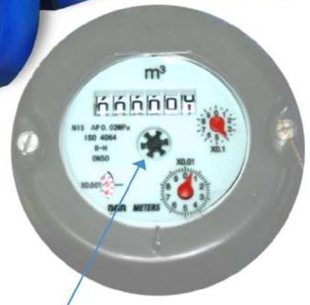
Estrella giratoria para detección de goteo/fugas y calibración electro óptica
