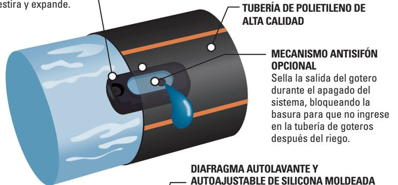
**TUBERÍA DE POLIETILENO DE ALTA CALIDAD**
