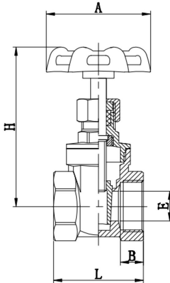
1. Válvulas de compuerta de latón hembra x hembra de flujo total con mango de hierro fundido.
